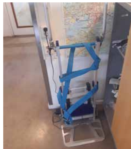
En batteridrivna trappklättrare.
